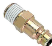
IB6NMC2 88103015 Embout Gamme IBN/IBS, filetage mâle 1/4", passage 6 mm (ISO6150B / MIL- C4109)
