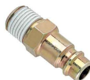
IB6NMC2 88103015 Embout Gamme IBN/IBS, filetage mâle 1/4", passage 6 mm (ISO6150B / MIL- C4109)
